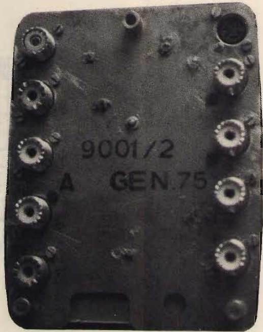
Vista inferiore del commutatore realizzato nella scatola URMET.
