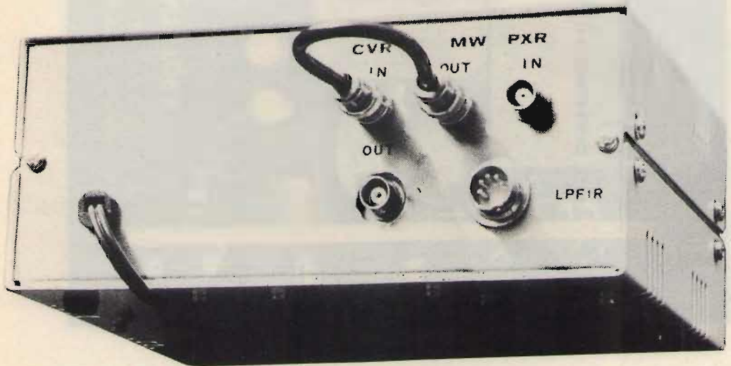
Posteriore del modulo "active antenna system".
